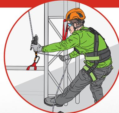
Une « clé de sécurité » doit être réalisée par l'intermédiaire d'un nœud pour éviter une éventuelle erreur de manipulation.
